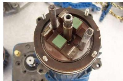
Retirer successivement chaque élément jusqu'au disque de friction inclu.
