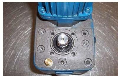
Le carter est poussé de l'intérieur par deux ressorts. Mesurer l'écartement obtenu entre les deux carters sous l'action de la détente des deux ressorts.
