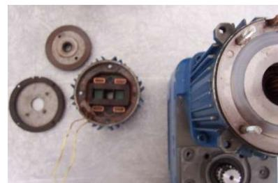
A l'aide d'un tournevis plat inséré dans les encoches latérales, séparer les deux carters.
