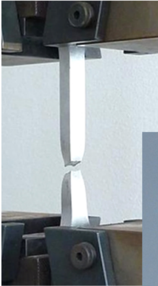
Striction à 45° d'une éprouvette de traction de section carrée.
