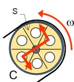
$$P(\vec{S}/S/R) = \vec{C}(\vec{S}/S) \cdot \vec{\omega}(S/R) [W]$$
