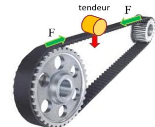
Origine de F : l'arbre est entraîné en rotation par une transmission poulie+courroie. Celle-ci doit être tendue pour bien fonctionner.
