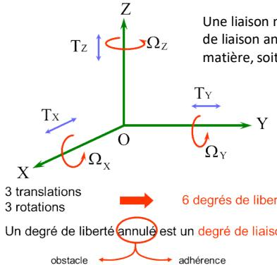
Une liaison mécanique admet des degrés de liberté et des degrés de liaison. Le degré de liaison annule le degré de liberté. Pour ceci on utilise soit un obstacle constitué de matière, soit l'adhérence, ou bien les deux en même temps... 2 exemples :
