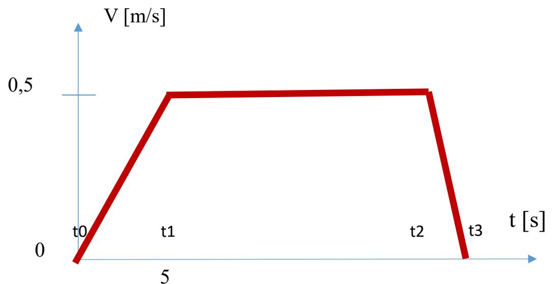
$$a = \frac{v_1 - v}{t_1 - t_0} = 0,1 \text{ m/s}^2$$
