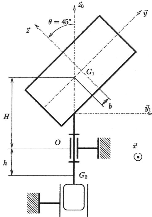
On souhaite connaître la valeur du couple moteur  $C$  qui permet de mettre en rotation le solide ( $S$ ) d'une vitesse initiale nulle ( $\psi'_{(t=0)} = 0$ ) à la vitesse de ( $\psi'_{(t=T)} = \psi'_0$ ) en un laps de temps  $T$ .
