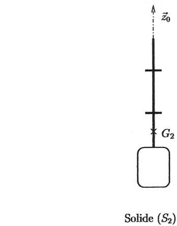
La solide ( $S$ ) est en liaison pivot parfaite d'axe  $(O, \vec{z}_0)$  avec le repère galiléen  $Ro(O; \vec{x}_0, \vec{y}_0, \vec{z}_0)$ .
